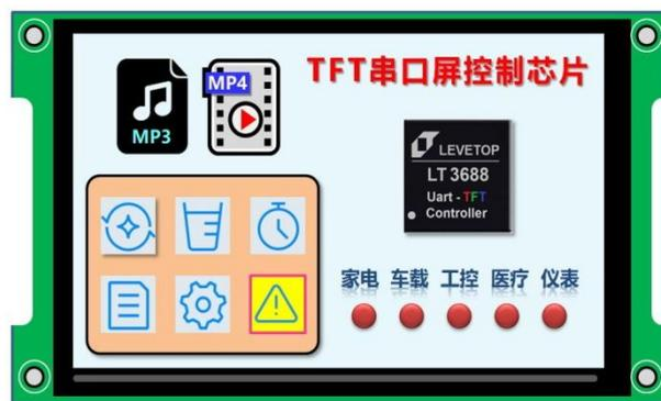
LT3688 主频为 400MHz，含有 512Mb DDR 显示内存，内建 MCU 程序支持大部分 乐升半导体的串口屏通讯协议，包括图片显示、图片卷动、画中画 (PIP)、GIF 动画显示、几何图形、矢量文字显示、二维码生成等功能，主要特点在于 TFT 串口屏上支持 MP4 视频播放及 MP3 音乐播放，配合 乐升半导体的串口屏开发软件能迅速实现产品的带 TFT 屏显示功能。除了提供 Uart 串口通讯，也提供 USB2.0 及一些模拟输入 AIN、PWM 及 INT 中断接口，这些接口也可以设置成普通 IO 接口。LT3688 非常适合用在有 TFT-LCD 屏的电子产品上，尤其是需要视频播放、带小尺寸 TFT 屏的电子产品，如各式智能家电、汽机车仪表盘、工业控制、电子仪器、医疗设备、人机接口、检测设备等产品。
