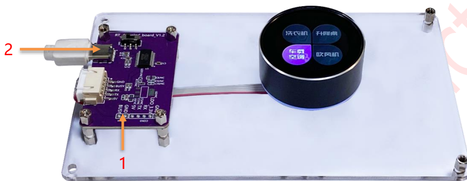
图 2-22: LT168A 接线示意图
