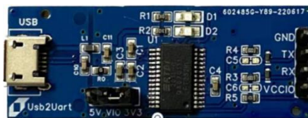
图 2-11: USB 转 TTL 模块
