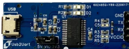
图 2-11: USB 转 TTL 模块
