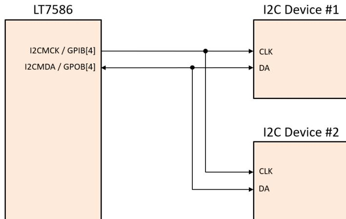
图 13-15：LT758x 串行 I2C 应用电路
