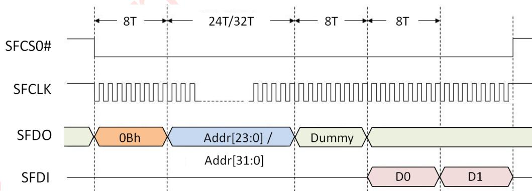
图 13-8: SPI 闪存的快速读取命令
