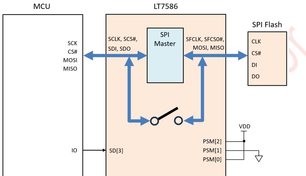
图 13-5: LT758x By-Pass Mode 示意图
