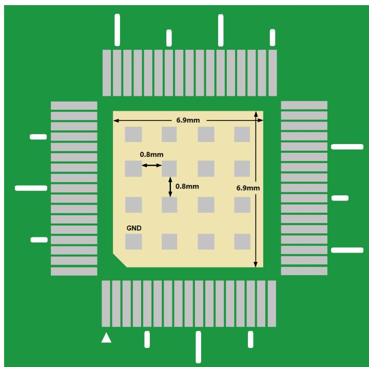
图 18-4：LT7580 底部焊盘 PCB 的设计建议
