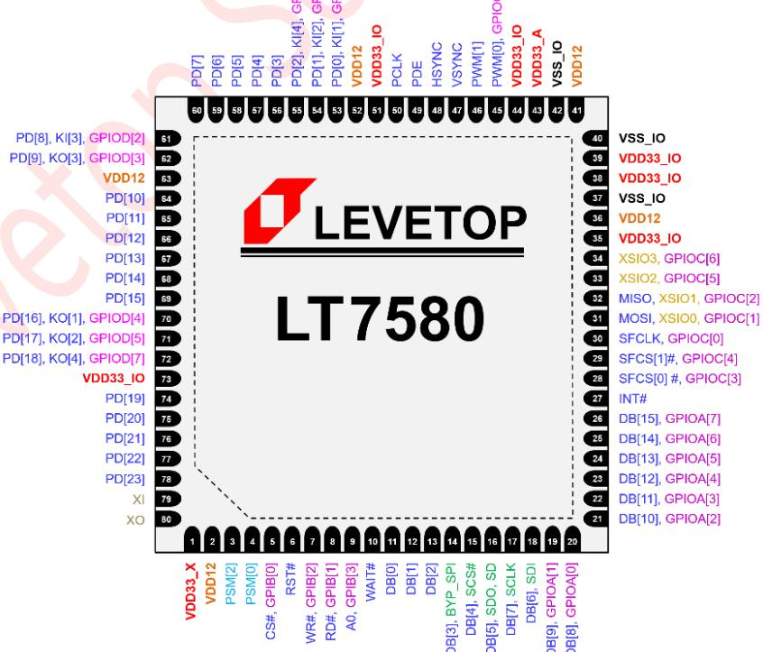
图 1-6: LT7580 引脚图 (QFN-80Pin)
