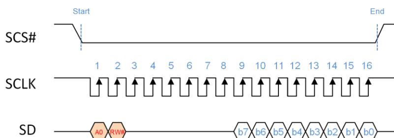
图 5-6: MCU 3 线 SPI 串联界面时序图
