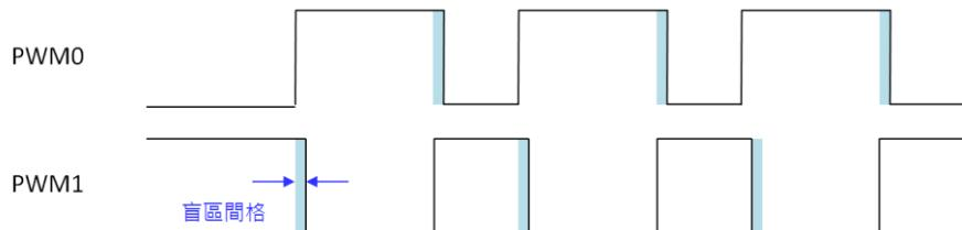
图 12-3：PWM0 和 PWM1 互补输出的盲区时序
