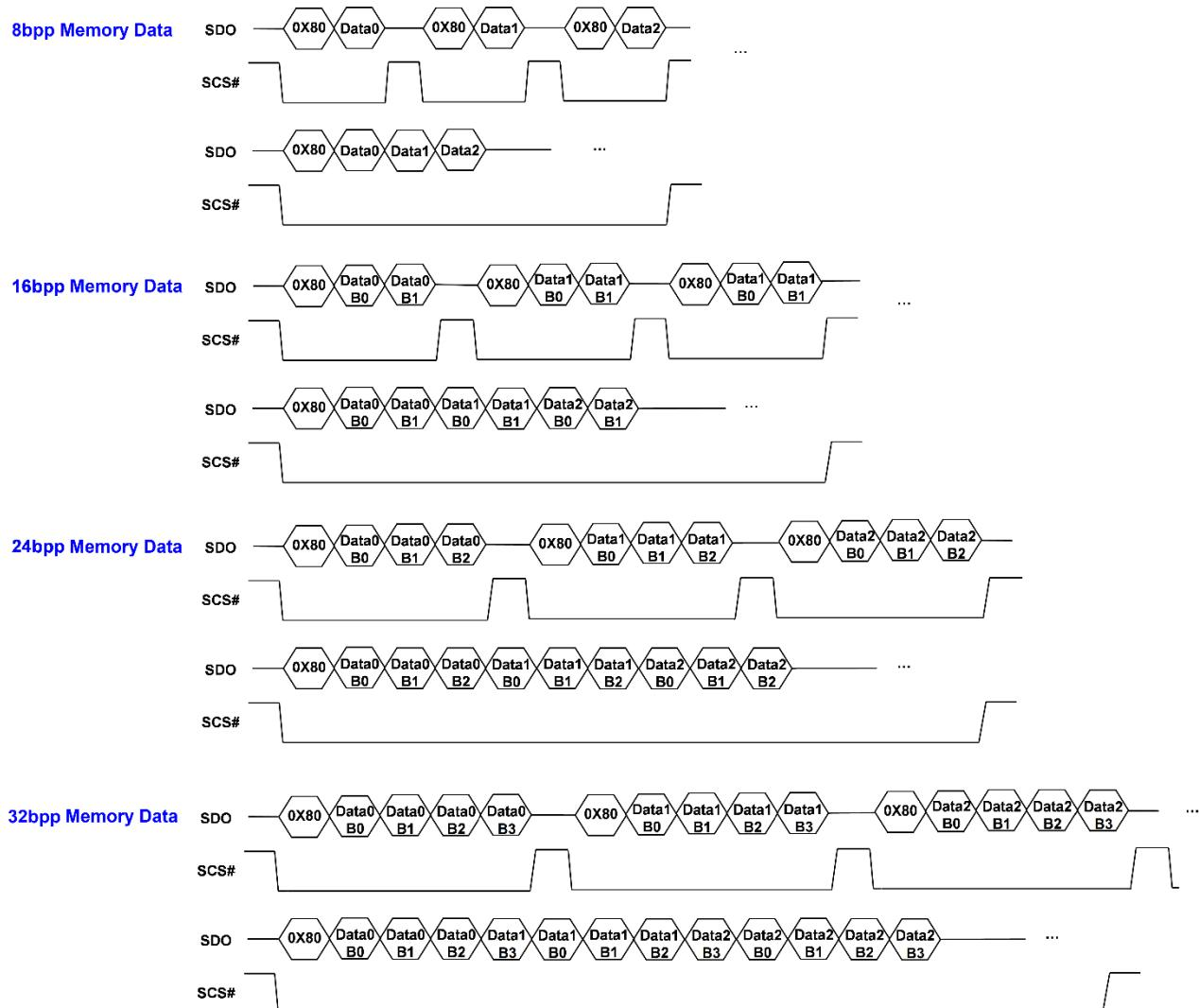
图 5-11: MCU 4 线 SPI 串联回写入显示内存的数据格式
