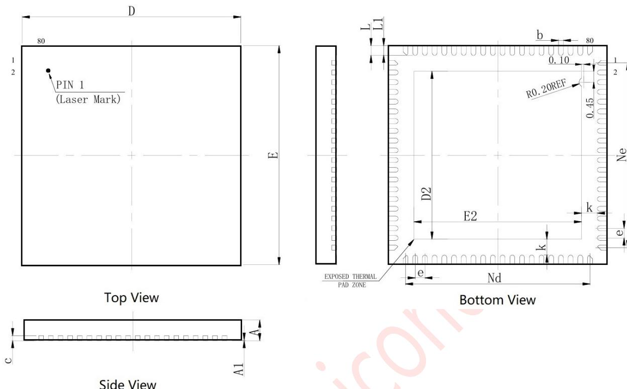
图 18-3: QFN-80Pin 外观尺寸图
