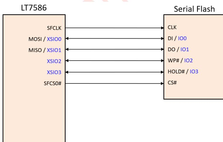
图 13-4: LT758x 串行 4 线 QSPI Flash 应用电路
