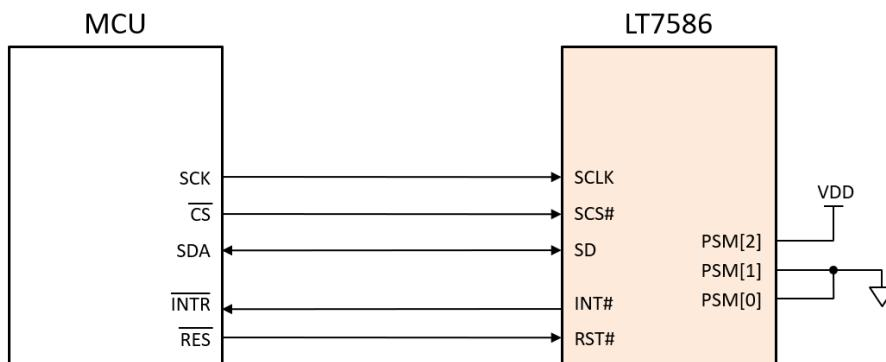
图 5-5: MCU 3 线 SPI 串联接口电路图
