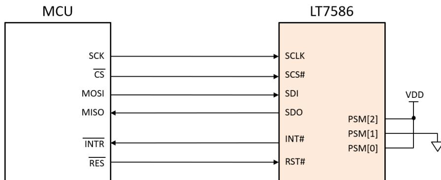
图 5-8：MCU 4 线 SPI 串联接口电路图
