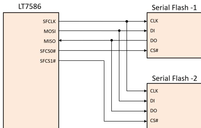
图 13-3: LT758x 串行 SPI Flash 应用电路
