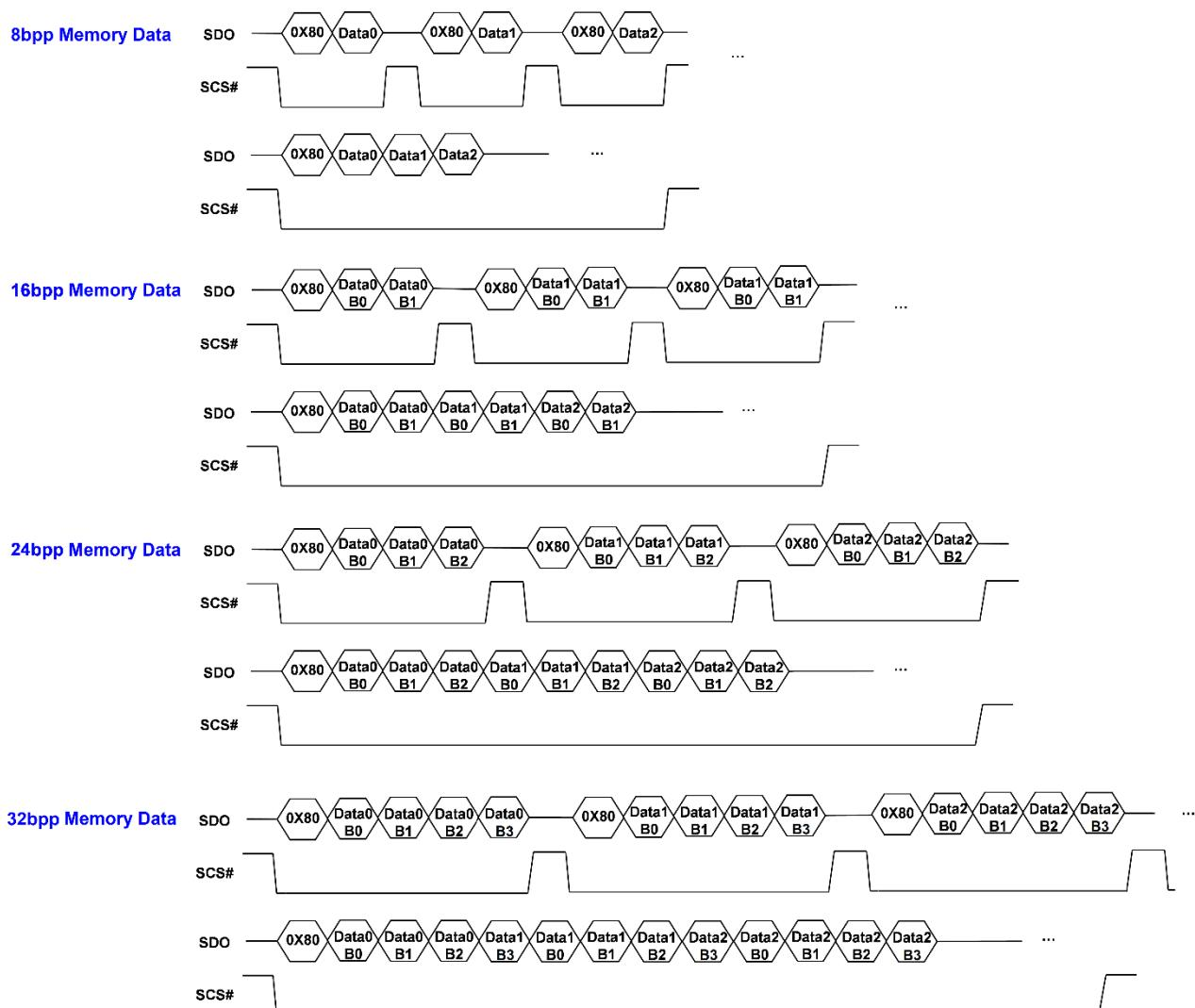
图 5-7: MCU 3 线 SPI 串联回写入显示内存的数据格式
