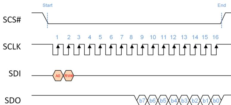
图 5-10：MCU 4 线 SPI 串联接口读取时序图
