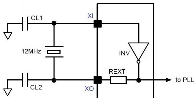
图 4-1：晶振电路
