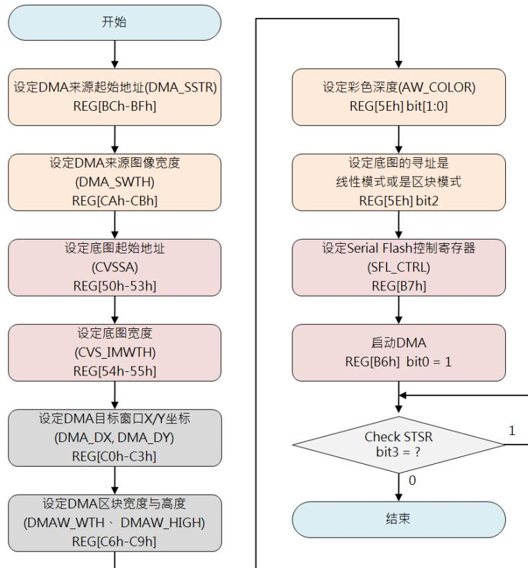
图 13-13: DMA 传输流程图 (轮询状态模式)
