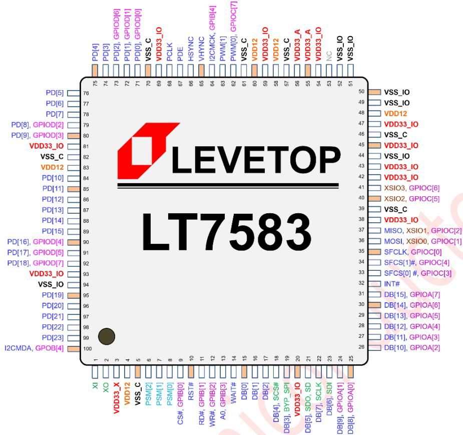
图 1-5: LT7583 引脚图 (LQFP-100Pin)
