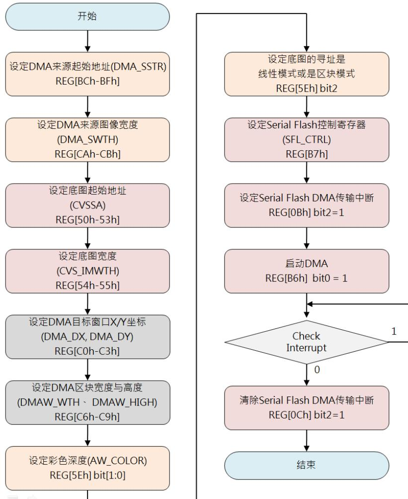
图 13-14: DMA 传输流程图 (使用中断模式)
