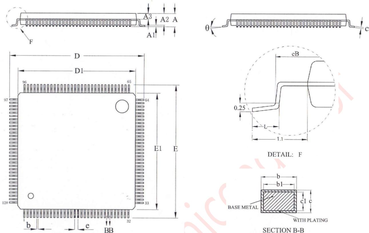
图 18-2: LQFP-100Pin 外观尺寸图
