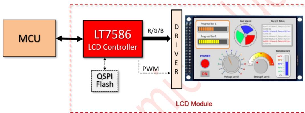
图 1-3: LT7586 设置在 LCD 模块上
