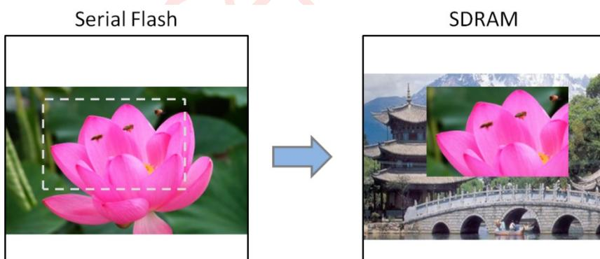
图 13-12：串行闪存的区块模式 DMA 传输
