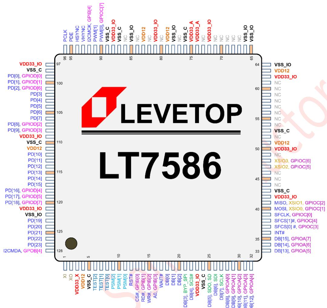
图 1-4: LT7586 引脚图 (LQFP-128Pin)
