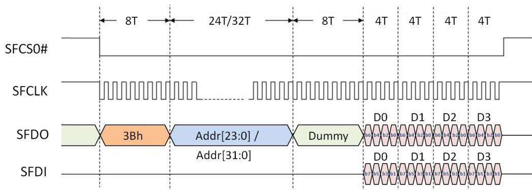
图 13-9: SPI 闪存的读取命令 (数据输入为交错式)
