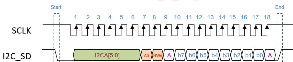
图 5-13：MCU I2C 串联界面时序图
