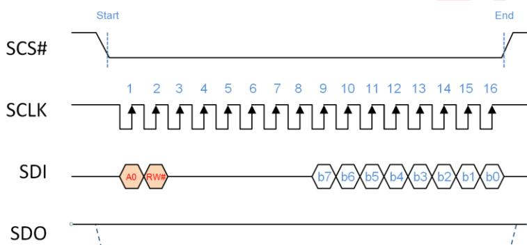
图 5-9：MCU 4 线 SPI 串联界面写入时序图
