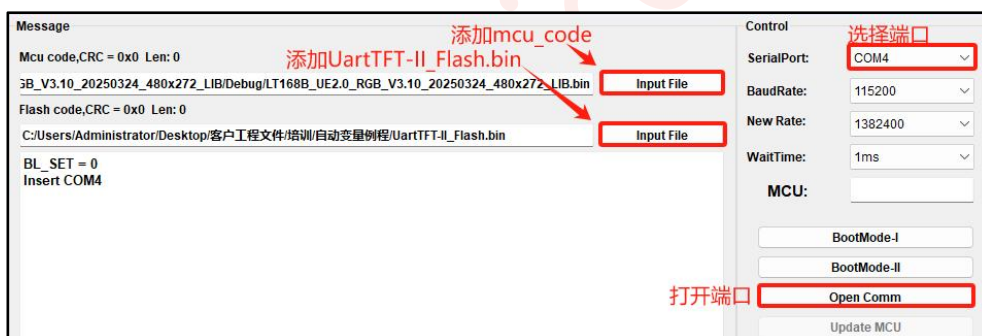
图 16-19: 连接端口
