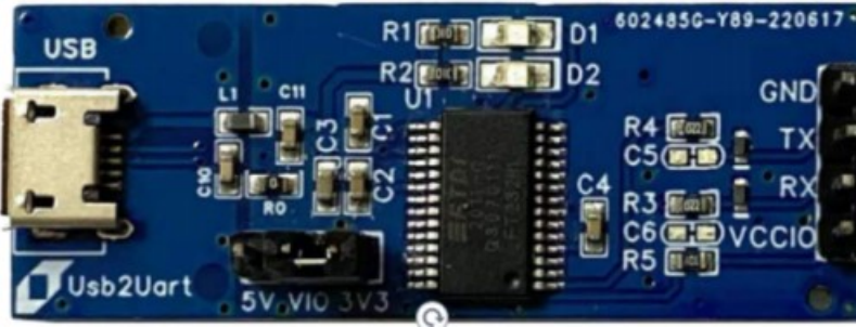
图 2-12: USB 转 TTL 模块
