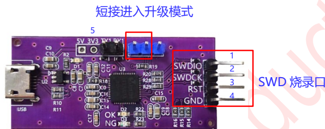
图 1-1: 烧录器 PCB 板外观图
