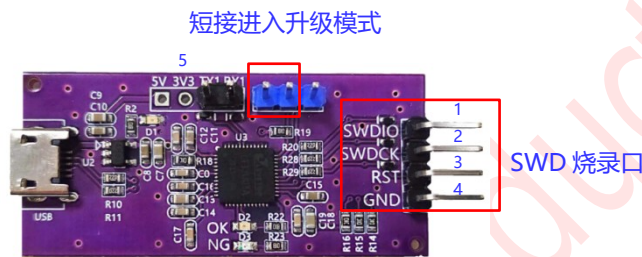
图 1-1: 烧录器 PCB 板外观图
