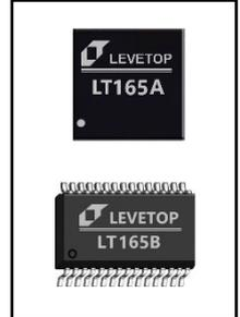
LT165 内部的主频可达 150MHz，含有 32KB SRAM，除了提供串口通讯，也提供一个 QSPI Flash 接口，用来快速读取储存在外部 SPI Flash 的程序代码、图片、动画等信息，LT165 可以配合乐升半导体研发的串口屏开发软件 (UI\_Editor)、模拟软件 (UI\_Emulator)，直接在电脑上进行产品的 UI 显示界面开发，其所支持的显示功能包括图片显示、GIF 动画显示、循环图片显示、进度条显示、显示、文字符串显示、PWM(DMA 模式) 音讯播放，及结合触控功能的多变量控制显示，除了提升显示效率外，也大幅缩短 TFT 显示的开发周期。此外，LT165 还提供另一组的 SCI (Uart) 接口可以连接如蓝牙模块或 WiFi 模块，也有包括 CanBus、模拟输入 AIN、PWM 及 INT 中断等接口，还有电容触控输入接口，这些也可设置成普通 IO 接口，同时自带 RTC 时钟，丰富的功能增加了串口屏的实用与适用范围，芯片特性符合车规标准设计与应用。LT165 可以支持双屏显示、或是并屏显示的应用，具有良好的流畅度与极高的性价比。
