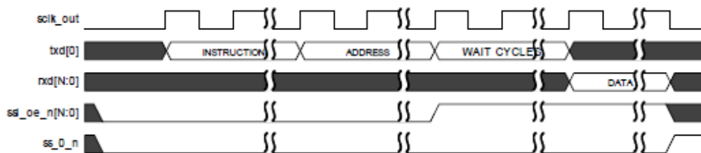
图 22-37：典型读取操作双/四/八 SPI 模式
