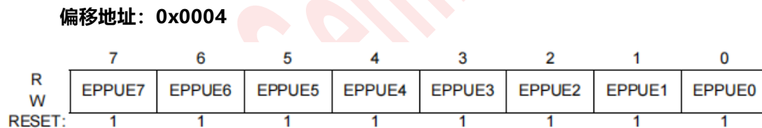
图 19-5: EPORT 引脚上拉使能寄存器 (EPPUE)
