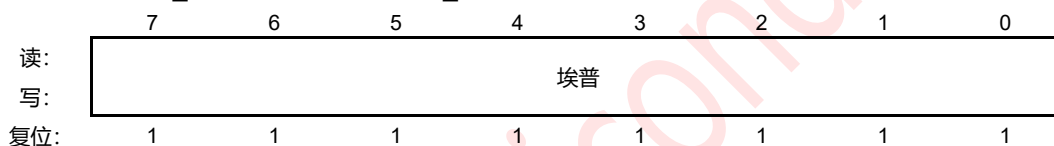
图 23-5: EPORT 引脚上拉式启用寄存器 (EPPUE)
